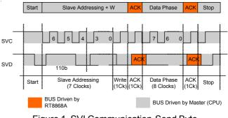
Figure 1. SVI Communication-Send Byte
